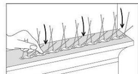
Die Länge der Module (3 Stk. für 1 m mit einem 3 cm Abstand zwischen jedem Modul für den Wasserabfluss) erleichtert die Verarbeitung. Die vorgefertigten Sollbruchstellen gestatten ein Verkürzen auf jede gewünschte Länge.
