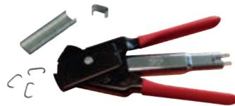
Das Werkzeug um Netze mit einer Hand am Seil zu befestigen.
